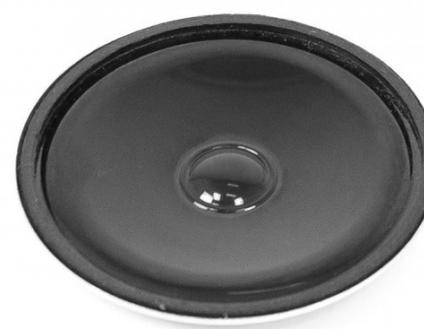
Мощность – от 1 Вт. Номинальное электрическое сопротивление – 8 Ом. Диапазон частот – 200-1500 Гц. Диаметр – 57 мм.
