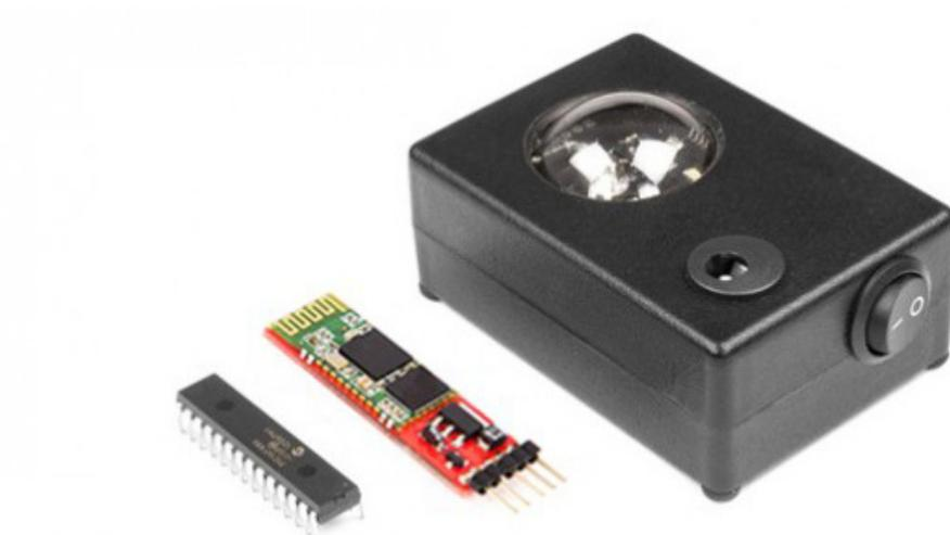
Предназначен для модернизации проводного оборудования. Подпаяв Bluetooth-модуль, сменив процессор на материнской плате и блок на повязке, вы получите адаптированный под современную игру лазертаг-комплект.
