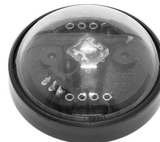
В комплект входят: крышечка сенсора с основанием, датчик TSOP, светодиод TLWR.
