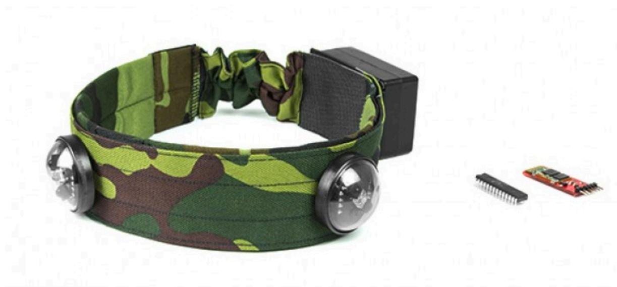
Усовершенствует ваше лазертаг-оборудование 4 поколения, позволив отказаться от проводных комплектов. Необходимо будет поменять процессор на плате и подсоединить универсальный Bluetooth- модуль.
