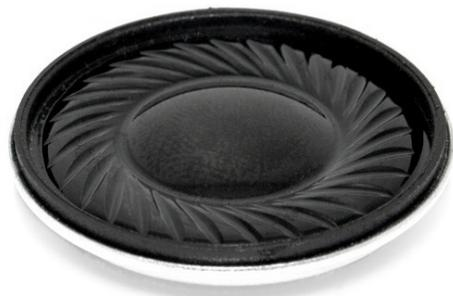
Динамик используется в игровых пистолетах LASERWAR. Мощность – 1,5 Вт. Номинальное электрическое сопротивление – 8 Ом. Диаметр – 28 мм.
