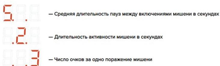
После того, как вы установили нужные значения, мишень автоматически сохранит все параметры в течение нескольких секунд. Затем нажмите на лазертаг-пульте кнопку «Новая игра» или «Старт игры», аркадный режим включён и в электронные мишени можно стрелять. В тире нет временных ограничений, инструктору необходимо самому контролировать время и останавливать игроков.
